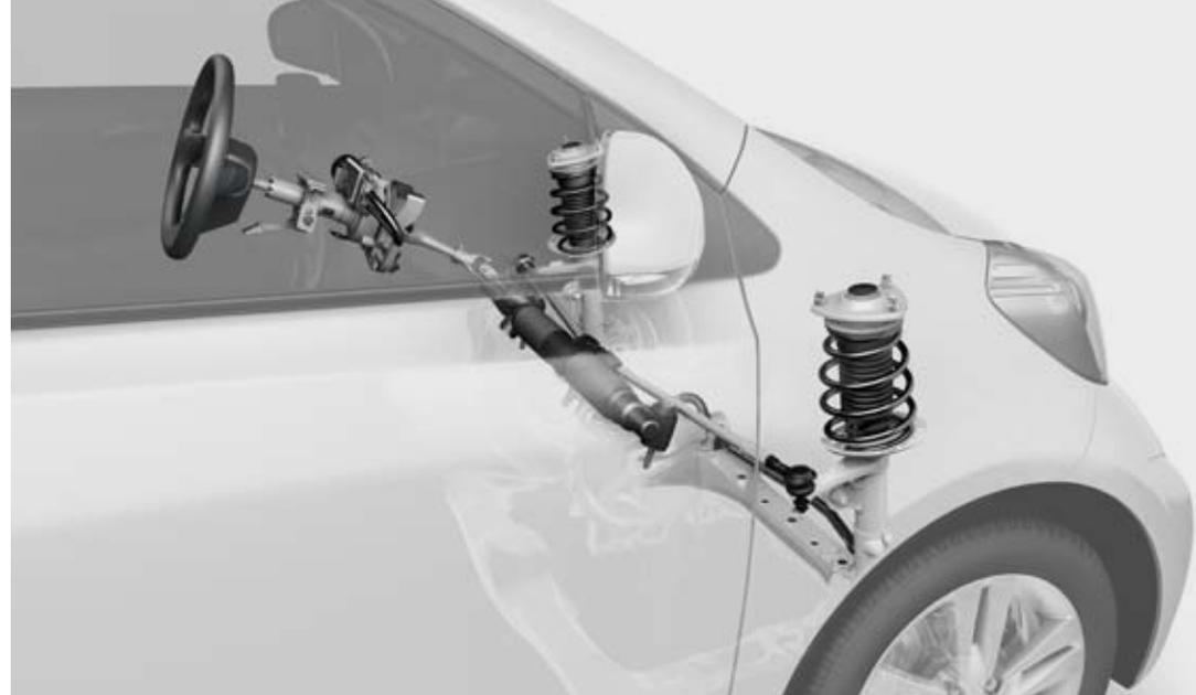
**2** La scelta di una scatola guida con leva take-off centrale ed il suo posizionamento più elevato nel vano motore hanno facilitato il riposizionamento della trasmissione, del motore e del differenziale. Il vano motore è stato conseguentemente ridotto, contribuendo ulteriormente alla riduzione dello sbalzo anteriore.
